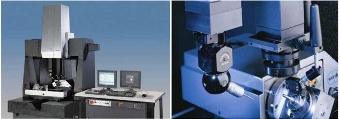
Werth 멀티센서 3차원측정기의 비접촉 비디오 카메라 센서는 고성능의 3차원 이미지 프로세서를 적용한 비접촉 3차원 카메라를 사용하므로 접촉식 센서에서 측정하는 것과 같이 비접촉 센서만으로 3차원 공간기준 설정 및 공간점, 경사면의 각도, 경사면의 R값, 구, 원뿔, 원통 등과 같은 3차원 형상의 측정요소를 모두 측정하고 평가할 수 있음은 물론, 평면도, 원통도, 진구도, 직각도(면포함), 평행도(면포함), 대칭도(면포함), 온-흔들림 등과 같은 ISO 1101에 의한 3차원 기하공차까지도 모두 평가할 수 있습니다.
